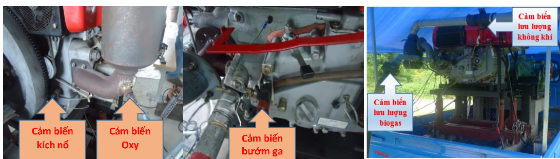
Hình 6. Bố trí các cảm biến và điều khiển
