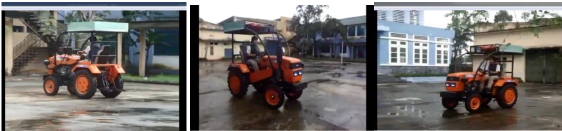
Hình 14. Hình ảnh thực hiện chạy thử nghiệm máy kéo diesel K2600
