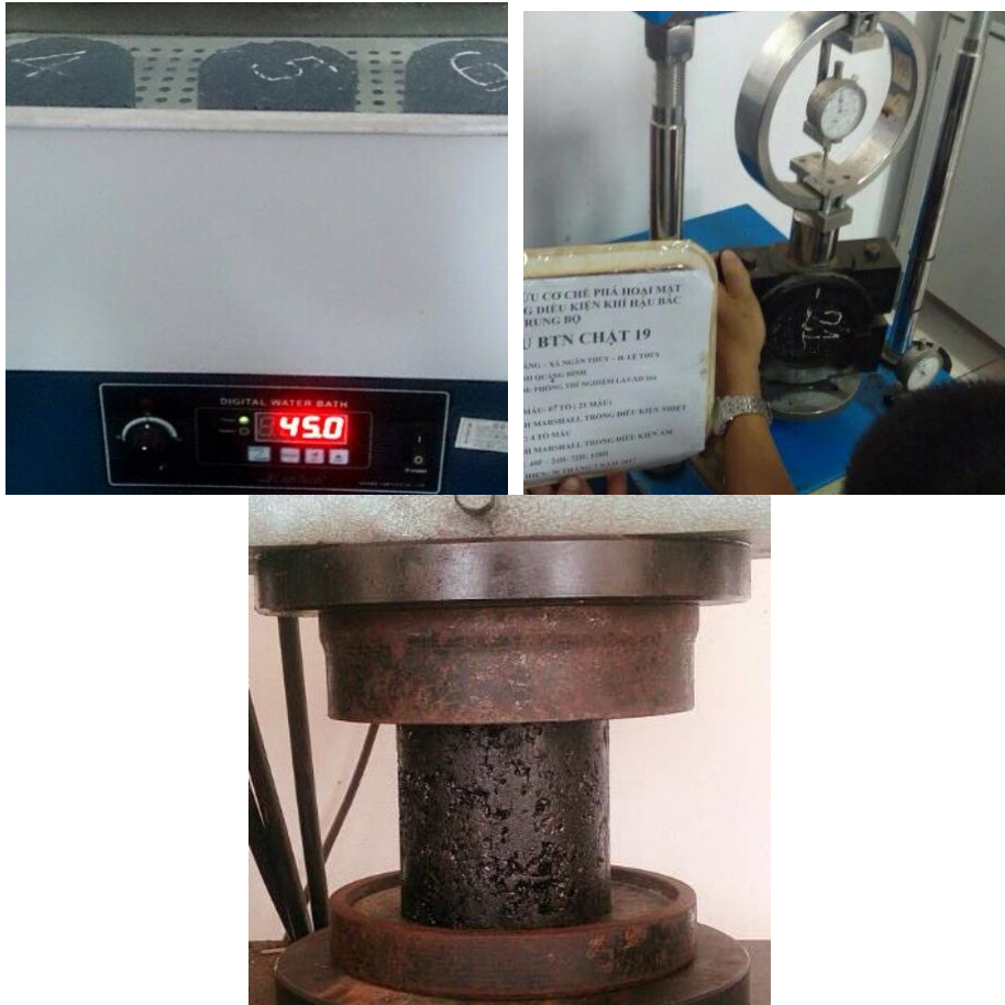
Hình 1. Thiết bị thí nghiệm tiêu chuẩn về nhiệt ẩm (trái), thí nghiệm IDT (giữa) và UC (phải).
