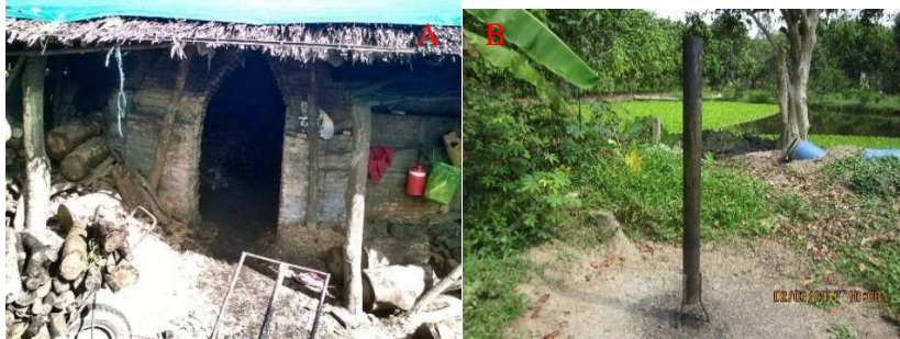
Hình 1. Lò tạo than thủ công (A) và ống sắt tạo than trấu (B)
